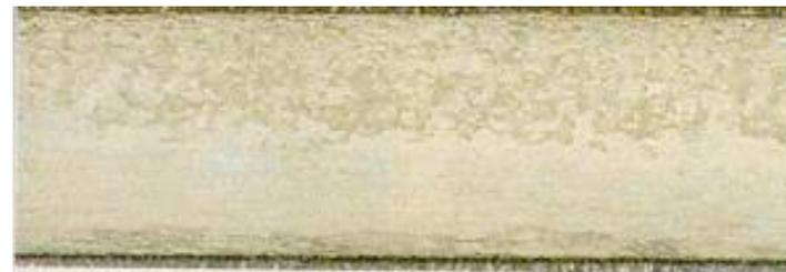
Отложения на поверхности трубки из латуни
