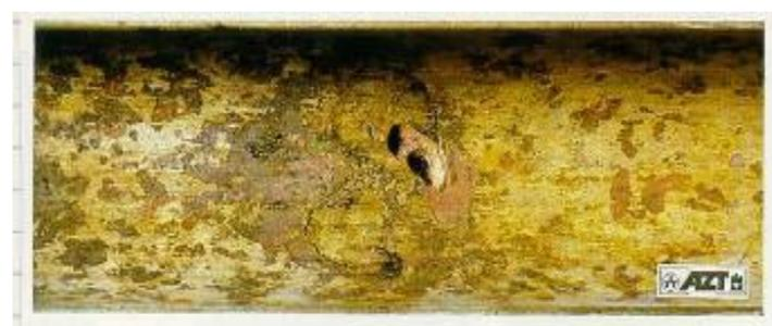
Локальная эрозия трубки конденсатора, вызванная застрявшим крупным загрязнением
